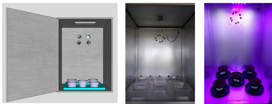
Gambar 1. Instalasi Grow Box dengan cahaya buatan dari LEDs
