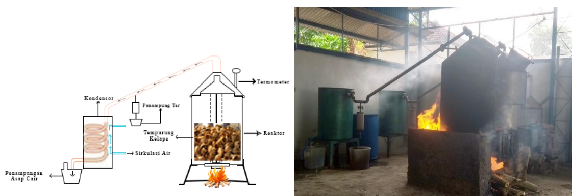
a). Skema proses pirolisis tempurung kelapa; b). Proses pirolisis tempurung kelapa
