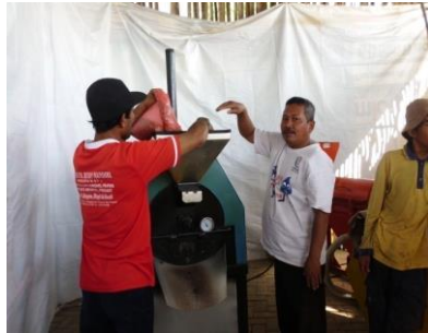
Gambar 6. Menggoreng kopi dengan mesin dan Blower Pendingin Korengan Kopi
