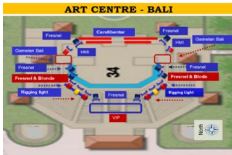
Gambar 15 : Floor Plan Open Stage, Art Centre dan penempatan lampu.
