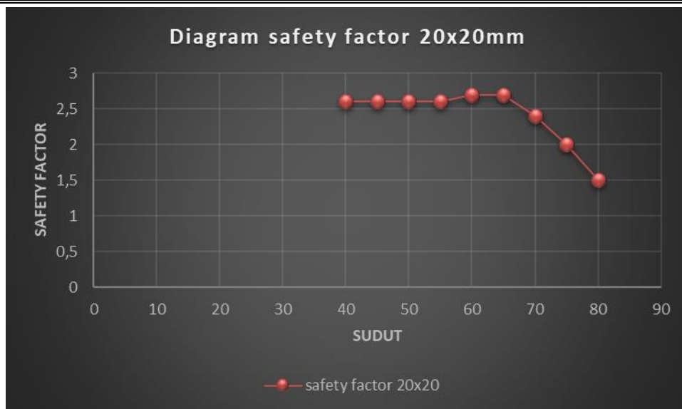
Gambar 6. Grafik safety of factor dari variasi material pipa hollow 20x20 mm
