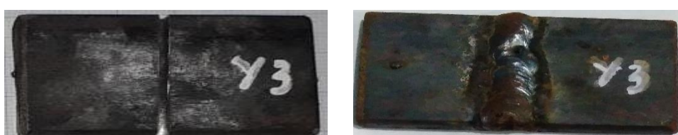
Gambar 2. Bentuk kampuh double V sebelum dan sesudah disambung
