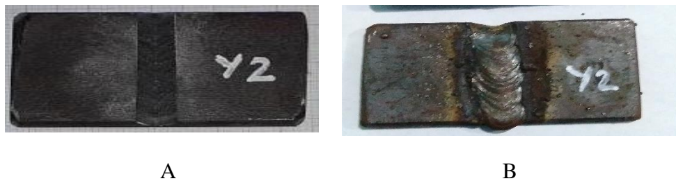
Gambar 1. Bentuk kampuh V sebelum dan sesudah disambung
