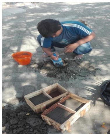
Gambar 10. Proses pencampuran dan pencetakan batako
