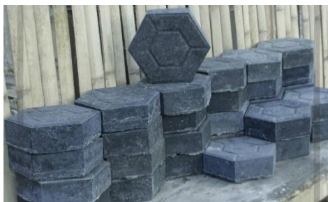
Gambar 1: Paving dari hasil pengolahan sampah
