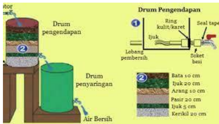
Gambar 1. Modifikasi slow sand filter 20 cm
